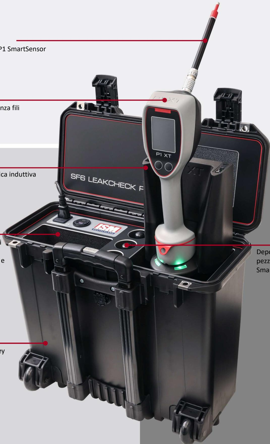
Novità mondiale: Visualizzazione chiara dello stato con proiettore LED multicolore **Allarme** nel campo visivo diretto dell'ispettore
