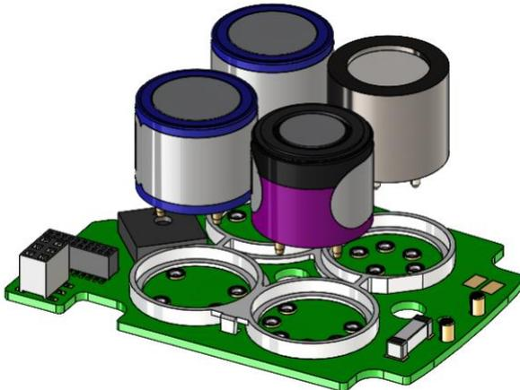
6. Inserte el nuevo sensor en la PCB del sensor en la orientación correcta.
