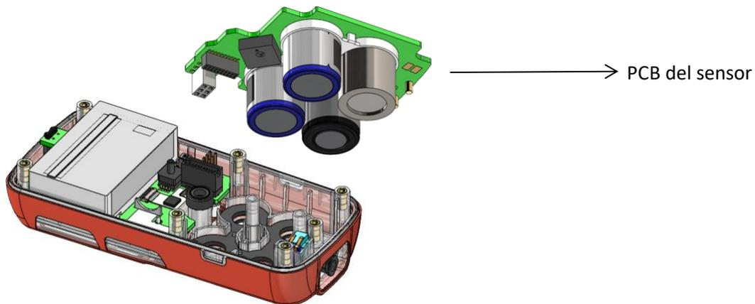
5. Separe el sensor que se va a reemplazar de la PCB del sensor.
