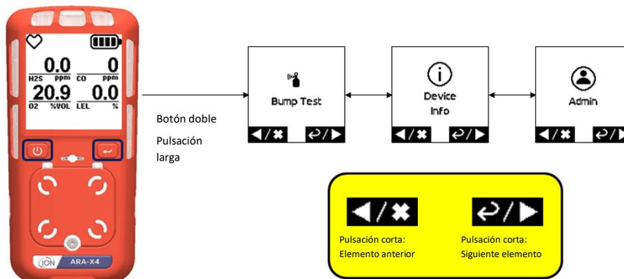
En el modo de Menú de administración, puede configurar el dispositivo, verificar su estado o realizar mantenimiento mediante estas opciones:
