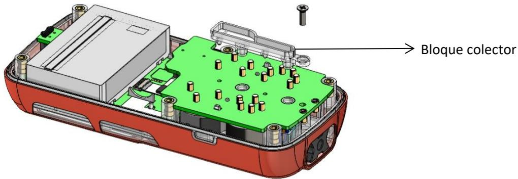
4. Desconecte la PCB del sensor de la PCB principal.
