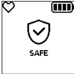
È possibile configurare la modalità SAFE collegandosi ad ARA-X Manager tramite la docking station ARA-X o IR Link, oppure direttamente tramite il menu del dispositivo.
