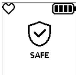
Pode configurar o modo SAFE ligando-se ao ARA-X Manager através da ARA-X Docking Station ou do IR Link, ou diretamente através do menu do dispositivo.
