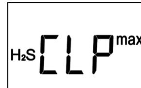
如果显示 CLP（清除峰值）时用户按下按钮，检测器上的峰值将被重置，并且不会显示“max”图标。
