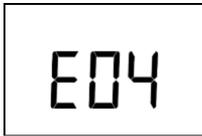
Trascorse 3 ore, se l'unità visualizza "E04", la tensione della batteria sarà troppo bassa o inferiore a un determinato livello.
