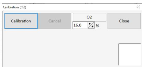
Ensuite, cliquez le bouchon d'étalonnage sur l'orifice d'entrée du capteur, puis ouvrez la vanne du détendeur manuel de débit fixe. L'écran de l'ARA affiche alors C90 et commence à décompter C89, C88 etc. pendant environ 20 secondes pour l'ARA Oxygen et 90 secondes pour les autres versions.
