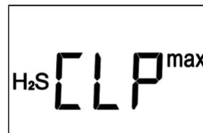
Betätigt der Benutzer die Taste, während das Symbol „CLP“ (Clear Peak - Spitzenwert löschen) angezeigt wird, so wird der Spitzenwert im Detektor rückgesetzt und das Symbol „
