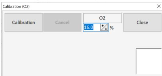
HINWEIS: Stellen Sie sicher, dass der Span-Wert der Kalibriergaskonzentration entspricht. Wenn nicht, verwenden Sie die Auf- und Ab-Pfeile zum Einstellen (siehe das Etikett auf der Kalibriergasflasche)
