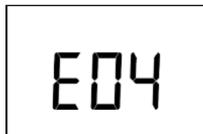
Zeigt das Gerät „E04“ an, ist die Akkuspannung nach Ablauf von 3 Stunden zu niedrig oder unterhalb eines bestimmten Werts.
