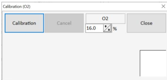
Klicken Sie nun die Kalibrierkappe auf den Sensoreinlassanschluss und öffnen Sie dann das Ventil am manuellen festen Durchflussregler. Der Bildschirm des ARA zeigt dann C90 an und beginnt, C89, C88 usw. ungefähr 20 Sekunden lang für den Sauerstoff-ARA und 90 Sekunden lang für die anderen Versionen herunterzuzählen.
