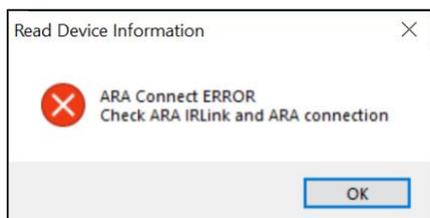
Justieren und positionieren Sie den ARA einfach relativ zum IR-Link. Wenn Sie dies einige Male versucht haben und keinen Erfolg hatten, wenden Sie sich bitte an ION Science.
