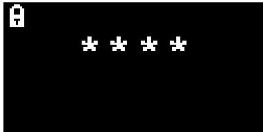
按 Enter 键。光标将显示在第一个星号下方。按向上 或向下 键。星号将被数字替换。继续按向上和向下键，直到显示密码的第一位数字。
