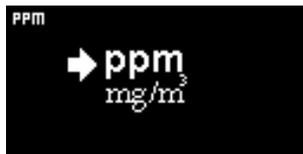
用于将检测单位从默认的 ppm 更改为毫克每立方米 (mg/m<sup>3</sup>)。
