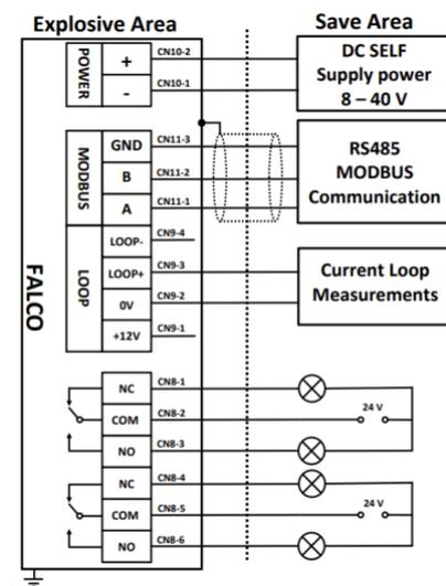
Abbildung mit typischem Anschlussschaltbild.
