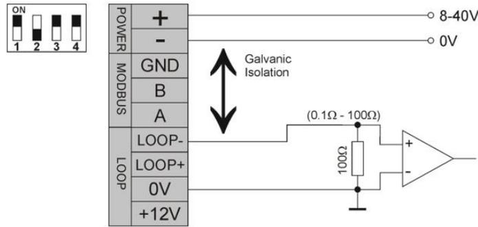
FALCO 2 11.7 Stromschleifenkonfiguration 1 – aktive Stromschleife, unter Verwendung einer internen Stromversorgung, die an die Stromquelle angeschlossen ist.
