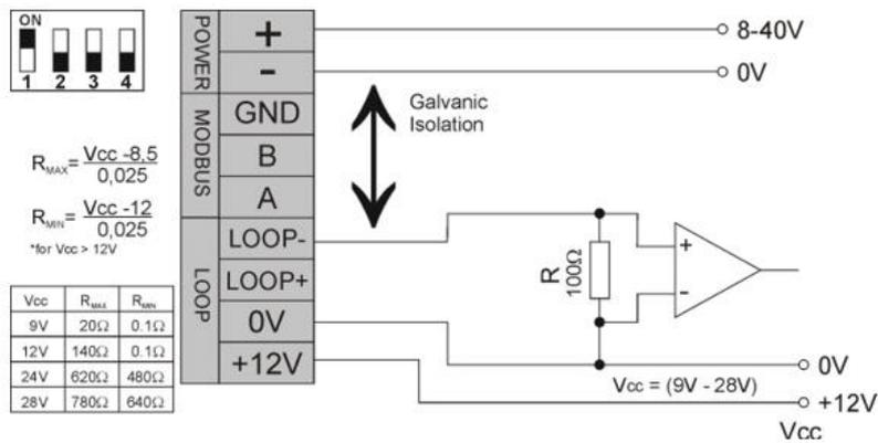
FALCO 2 11.7 Stromschleifenkonfiguration 3 – passive Stromschleife, extern gespeiste Stromquelle
