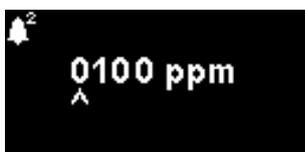
Se utiliza para configurar el nivel de ppm al que se activa la Alarma 2 (roja). Al acceder a esta función, la pantalla muestra el nivel actual.
