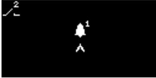
Se utiliza para especificar cuál de las 4 condiciones activará la salida del relé 2.
