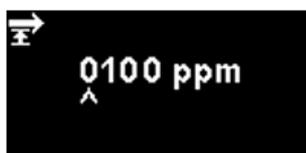
La limite inférieure de la plage de sortie de 4 mA à 20 mA, mappée sur 4 mA, est de 0 ppm. Cette option permet de définir la limite supérieure, mappée sur 20 mA.
