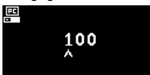
Utilisé pour sélectionner une adresse esclave Modbus.
