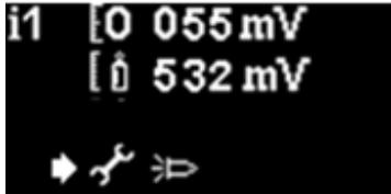
Das Lampensymbol auf dem Bildschirm zeigt an, ob der Sensor-Servicemodus ein- oder ausgeschaltet ist.
