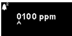
Dient zum Einstellen des ppm-Werts, bei dem Alarm 2 (rot) ausgelöst wird. Beim Aufrufen wird der aktuelle Wert auf dem Bildschirm angezeigt.
