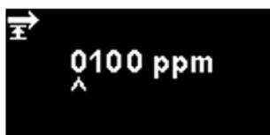
Die untere Grenze des Ausgangsbereichs von 4 mA bis 20 mA, abgebildet auf 4 mA, beträgt 0 ppm. Mit dieser Option wird die obere Grenze, abgebildet auf 20 mA, eingestellt.
