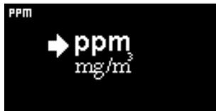
Wird verwendet, um die Erkennungseinheiten vom Standardwert ppm in Milligramm pro Kubikmeter (mg/m<sup>3</sup>) zu ändern.
