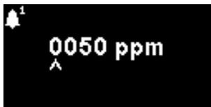
Dient zum Einstellen des ppm-Werts, bei dem Alarm 1 (gelb) ausgelöst wird. Beim Aufrufen wird der aktuelle Wert auf dem Bildschirm angezeigt.
