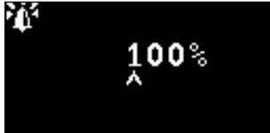
Dient zum Einstellen der Helligkeit der Statusleuchte bei Alarmbedingungen, von 0 bis 100 % für Grün und 50-100 % für Gelb und Rot. Der Helligkeitsmodus „AUTO“ wird durch Einstellen der Helligkeit auf 0 % ausgewählt.
