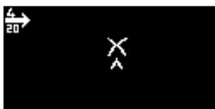
Dient zum Ein- und Ausschalten des 4 mA bis 20 mA-Ausgangs.
