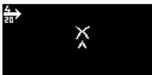
Se utiliza para activar y desactivar la salida de 4 mA a 20 mA.
