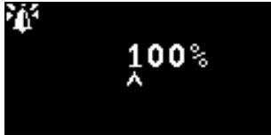
Se utiliza para configurar el brillo de la luz de estado durante las condiciones de alarma, de 0 a 100 % para verde y de 50 a 100 % para ámbar y rojo. El modo de brillo "AUTO" se selecciona configurando el brillo al 0 %.
