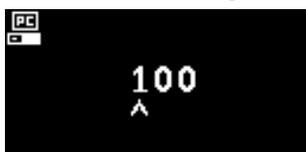
Se utiliza para seleccionar una dirección esclava Modbus.
