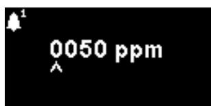
Se utiliza para configurar el nivel de ppm al que se activa la Alarma 1 (ámbar). Al acceder a esta función, la pantalla muestra el nivel actual.
