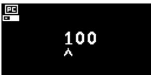
Utilisé pour sélectionner une adresse esclave Modbus.
