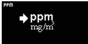
Permet de modifier les unités de détection par défaut de ppm en milligrammes par mètre cube (mg/m<sup>3</sup>).
