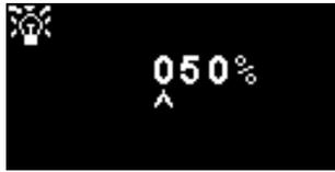
Permet de régler la luminosité du voyant d'état en cas d'alarme, de 0 à 100 % pour le vert et de 50 à 100 % pour l'orange et le rouge. Le mode de luminosité « AUTO » est sélectionné en réglant la luminosité sur 0 %
