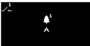
Permet de spécifier laquelle des 4 conditions déclenchera la sortie du relais 1. Chacune est représentée par un symbole, comme décrit ci-dessous.
