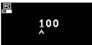
Utilisé pour sélectionner une adresse esclave Modbus.
