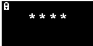
Utilisé pour activer et désactiver le verrouillage par mot de passe et pour modifier le numéro du mot de passe.
