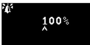
Permet de régler la luminosité du voyant d'état en cas d'alarme, de 0 à 100 % pour le vert et de 50 à 100 % pour l'orange et le rouge. Le mode de luminosité « AUTO » est sélectionné en réglant la luminosité sur 0 %
