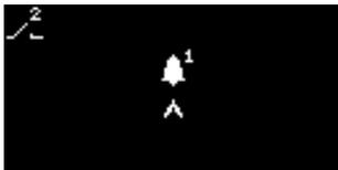
Utilisé pour spécifier laquelle des 4 conditions déclenchera la sortie du relais 2.
