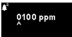
Utilizzato per impostare il livello ppm a cui viene attivato l'Allarme 2 (rosso). Quando si accede, lo schermo visualizza il livello corrente.
