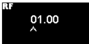
Impostare il fattore di risposta spostando il cursore e modificando i valori. Se viene immesso un fattore superiore a 10,00, quando si preme Invio
