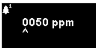
Utilizzato per impostare il livello ppm a cui viene attivato l'Allarme 1 (ambra). Quando si accede, lo schermo visualizza il livello corrente.
