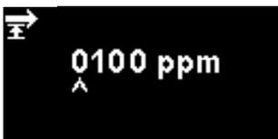
Il limite inferiore dell'intervallo di uscita da 4 mA a 20 mA, mappato a 4 mA, è 0 ppm. Questa opzione è utilizzata per impostare il limite superiore, mappato a 20 mA.
