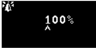
Utilizzato per impostare la luminosità della spia di stato durante le condizioni di allarme, da 0 a 100% per il verde e 50-100% per l'ambra e il rosso. La modalità di luminosità "AUTO" viene selezionata impostando la luminosità su 0%
