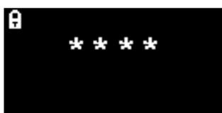
La schermata di blocco viene visualizzata se è stato specificato un numero di password (vedere menu i6). Protegge lo strumento da regolazioni non autorizzate: i menu (vedere sotto) non sono accessibili finché non viene immesso il numero corretto.
