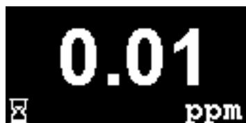
Lo schermo appare quindi in modo continuo e mostra la lettura PID e le unità. Il colore della spia di stato dipende dallo stato.
