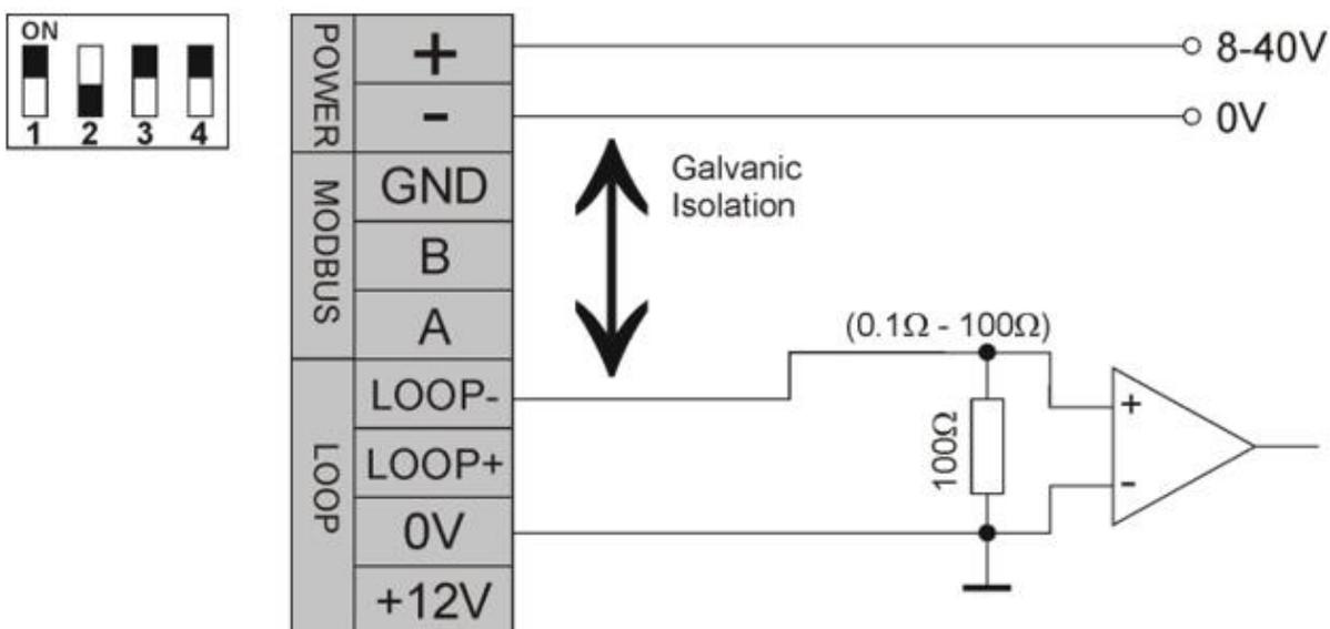
Falco Current Loop Configuração 1 – loop de corrente ativo, utilizando uma fonte de alimentação interna ligada à fonte de corrente.
