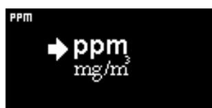
Utilizado para alterar as unidades de deteção do padrão de ppm para miligramas por metro cúbico (mg/m3).
