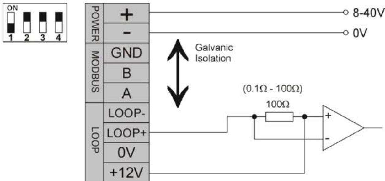
Configuração 4 do Falco Current Loop – loop de corrente ativo, utilizando uma fonte de alimentação interna ligada à fonte de corrente.
