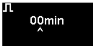
Le cycle de mesure peut être réglé de continu à 10 minutes avec des incréments de 1 minute
