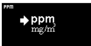
Utilisé pour modifier les unités de détection par défaut de ppm en milligrammes par mètre cube (mg/m<sup>3</sup>).
