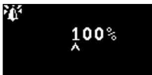
Permet de régler la luminosité du voyant d'état en cas d'alarme, de 0 à 100 % pour le vert et de 50 à 100 % pour l'orange et le rouge. Le mode « AUTO » est sélectionné en réglant la luminosité sur 0 %.
