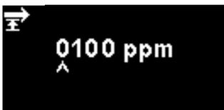
La limite inférieure de laLa plage de sortie de 4 mA à 20 mA, mappée sur 4 mA, est de 0 ppm. Cette option permet de définir la limite supérieure, mappée sur 20 mA.
