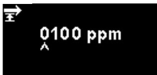
Il limite inferiore dell'intervallo di uscita da 4 mA a 20 mA, mappato a 4 mA, è 0 ppm. Questa opzione viene utilizzata per impostare il limite superiore, mappato a 20 mA.
