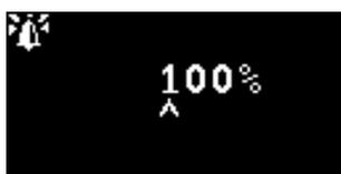
Utilizzato per impostare la luminosità della spia di stato in condizioni di allarme, dallo 0 al 100% per il verde e dal 50 al 100% per l'ambra e il rosso. La modalità di luminosità "AUTO" si seleziona impostando la luminosità allo 0%.
