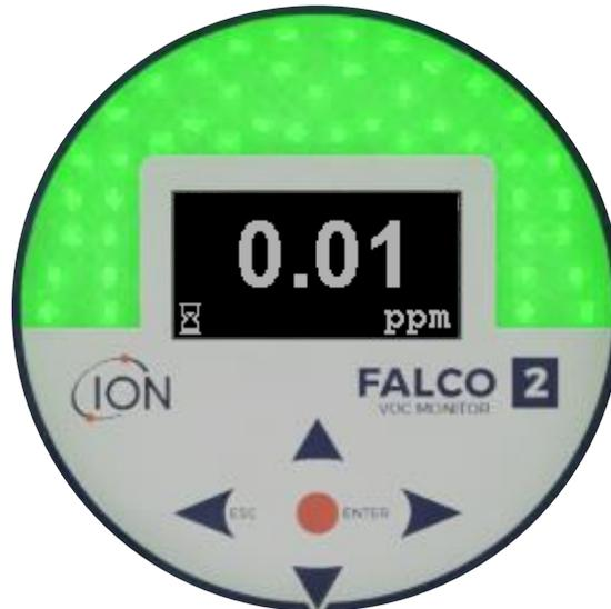
Lo schermo rimane quindi visualizzato in modo continuo, mostrando la lettura PID e le unità di misura. Il colore della spia di stato dipende dallo stato.
