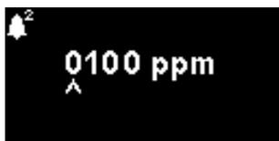
Utilizzato per impostare il livello di ppm al quale viene attivato l'Allarme 2 (rosso). Quando si accede, lo schermo visualizza il livello corrente.
