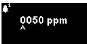
Utilizzato per impostare il livello di ppm al quale viene attivato l'Allarme 1 (giallo). Quando si accede, lo schermo visualizza il livello corrente.
