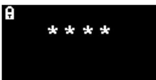
Utilizado para ativar e desativar o bloqueio da palavra-passe e para alterar o número da palavra-passe.
