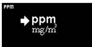
Utilizado para alterar as unidades de deteção do padrão de ppm para miligramas por metro cúbico (mg/m<sup>3</sup>).
