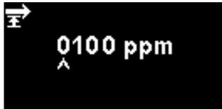
O limite inferior do intervalo de saída de 4 mA a 20 mA, mapeado para 4 mA, é de 0 ppm. Esta opção é utilizada para definir o limite superior, mapeado para 20 mA.
