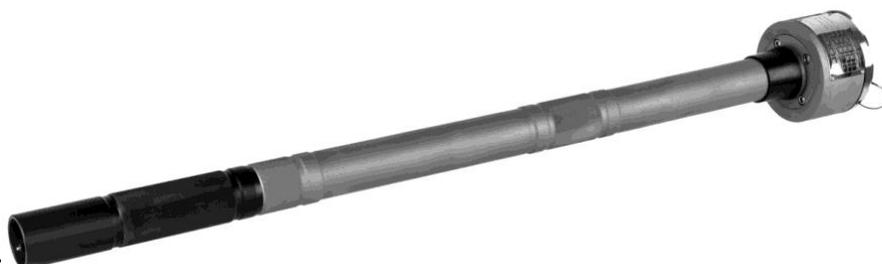
GasClam 2 是世界上第一个现场连续并眼气体监测和记录仪。它是可以检测各种气体浓度的宝贵工具，在检测应用中普遍需要。可检测气体包括甲烷 (CH<sub>4</sub>)，二氧化碳 (CO<sub>2</sub>)，氧气 (O<sub>2</sub>)，一氧化碳 (CO)，氢气硫化物 (H<sub>2</sub>S) 和挥发性有机化合物 (VOC)。
