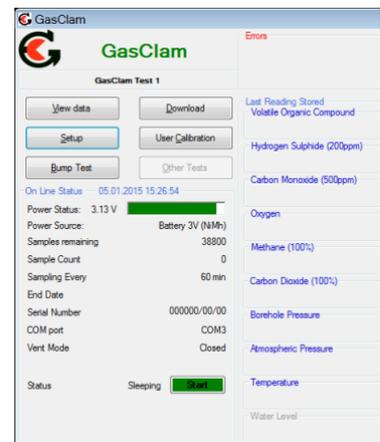
在确保电池类型和电压与新安装的电池相符之后，请通过单击“主页”窗口中的“设置”按钮，为监视应用程序（和特定钻孔）设置 GasClam 2。
