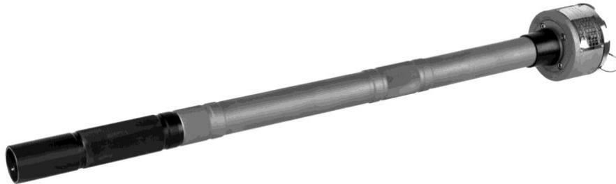
GasClam 2 es el primer monitor e instrumento de registro de gas de pozo continuo in situ del mundo. Es una herramienta invaluable para detectar y registrar la concentración de una amplia gama de gases comúnmente requeridos en aplicaciones de monitoreo, incluyendo metano (CH<sub>4</sub>), dióxido de carbono (CO<sub>2</sub>), oxígeno (O<sub>2</sub>), monóxido de carbono (CO), sulfuro de hidrógeno (H<sub>2</sub>S) y compuestos orgánicos volátiles (COV).
