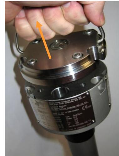
Si este procedimiento no se sigue al pie de la letra, se pueden producir daños en la junta tórica que podrían comprometer la seguridad intrínseca de la unidad.
