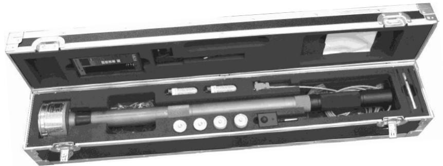
El GasClam 2 viene embalado para su transporte con tapas en las púas de entrada, salida y ventilación; estas tapas negras deben quitarse antes de utilizar la unidad. Si tiene la intención de almacenar la unidad durante un período de tiempo más prolongado, se recomienda volver a colocar las tapas de las púas para detener la entrada de humedad y polvo.
