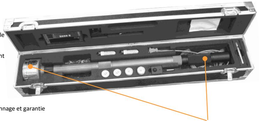
Le GasClam 2 est emballé pour le transport avec des capuchons sur les boulons de scellement d'entrée, de sortie et de ventilation. Ces capuchons noirs doivent être retirés avant l'utilisation de l'unité. S'il est prévu de stocker l'appareil pendant une période plus longue, il est recommandé de replacer les capuchons sur les boulons de scellement pour empêcher l'infiltration d'humidité et de poussière.
