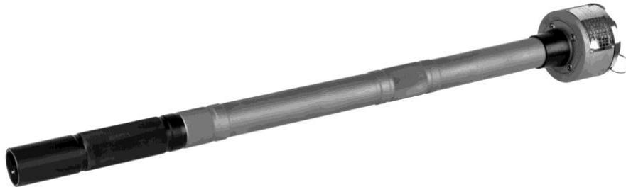
GasClam 2 est le premier instrument au monde de surveillance et de diagraphie in situ et en continu du gaz de forage. C'est un outil inestimable pour détecter et enregistrer la concentration d'un large éventail de gaz couramment requis dans les applications de surveillance : méthane (CH<sub>4</sub>), dioxyde de carbone (CO<sub>2</sub>), oxygène (O<sub>2</sub>), monoxyde de carbone (CO), sulfure d'hydrogène (H<sub>2</sub>S), composés organiques volatils (COV).
