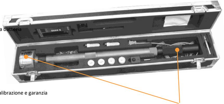
Il dispositivo GasClam 2 è imballato per il trasporto con tappi di raccordi di ingresso, uscita e sfiato. Questi **tappi neri** devono essere rimossi prima di poter iniziare a utilizzare l'unità. Se si prevede di conservare l'unità per un periodo di tempo più lungo, consigliamo di sostituire i tappi sui raccordi per bloccare l'ingresso di umidità e polvere.
