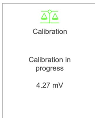
Sobald sich das Instrument stabilisiert hat, wird die Kalibrierung beendet. Um die Kalibrierung zu bestätigen, drücken Sie erneut auf „Ok“. Sie können die Kalibrierung bei Bedarf abbrechen. Die Kalibrierung wird dann auf dem Instrument gespeichert. Diese Kalibrierung wird automatisch der Benutzer-Ladefliste hinzugefügt.
