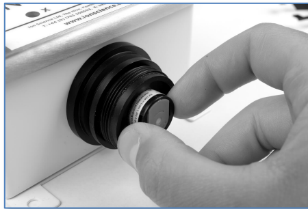
Chiffre17- Réinsérer le MiniPID 2 dans le boîtier du capteur TVOC 2
