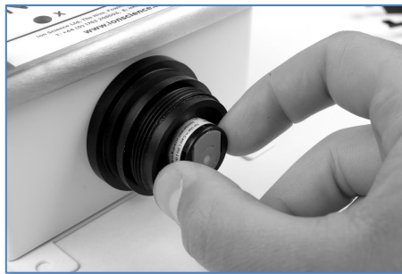
Figura17- Reinscrivere il MiniPID 2 nell'alloggiamento del sensore TVOC 2
