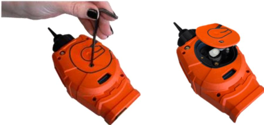
Lösen Sie an der Sensorabdeckung die untere linke Schraube mit einem passenden Inbusschlüssel. Heben Sie den MiniPID 2-Sensor vorsichtig vom Gerätekörper ab. Befolgen Sie die Anweisungen im obigen Abschnitt.
