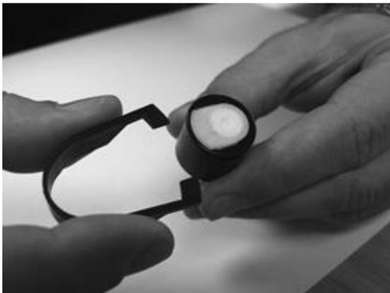
Suchen Sie mit dem mitgelieferten Mini-PID-Elektrodenstapel-Entfernungswerkzeug dessen „Zinken“ in den Schlitzen an der Seite des Mini-PID-2-Sensorgehäuses:
