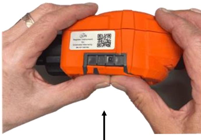
Sobald Sie hörenes hat sich engagiert, drücken Sie den Rest der Sensorabdeckung auf den Gerätekörper und schrauben Sie die untere linke Schraube fest mit dem 3-mm-A/F-Inbusschlüssel.
