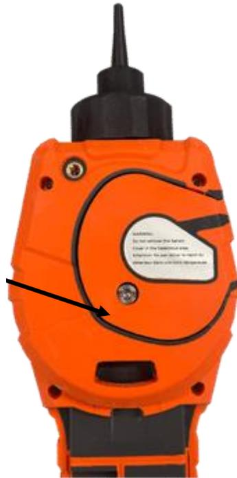
Sobald die Schraubelocker, sanftziehen Sie die rechte Seite der Sensorabdeckung vom Gerätekörper, bis Sie spüren, dass sich die Sensorabdeckung von den Einlass-/Auslassöffnungen gelöst hat. Einmal ist unbetätigt, ziehen Sie die gesamte Sensorabdeckung vorsichtig vom Instrumentenkörper ab.
