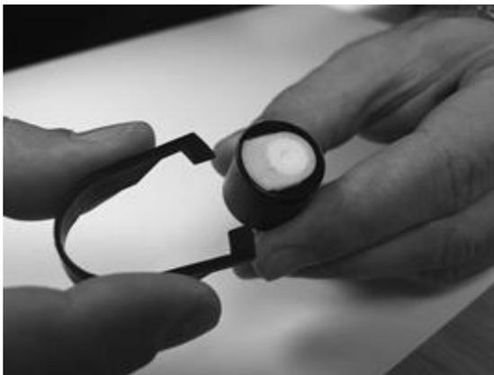
使用提供的 Mini PID 电极堆栈拆卸工具，将其“叉子”放置在 Mini PID 2 传感器主体侧面的插槽中：
