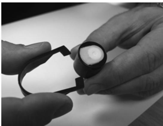
Utilizzando l'attrezzo per la rimozione dello stack di elettrodi Mini PID fornito in dotazione, individuare i suoi "rebbi" nelle fessure presenti sul lato del corpo del sensore Mini PID 2:
