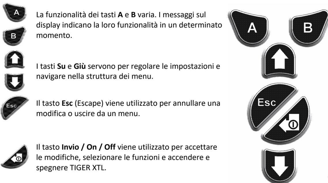
In generale, le impostazioni di configurazione e di applicazione vengono selezionate e regolate tramite i tasti funzione. Le opzioni vengono selezionate con i tasti freccia e confermate con il tasto **Invio** o con un tasto funzione.
