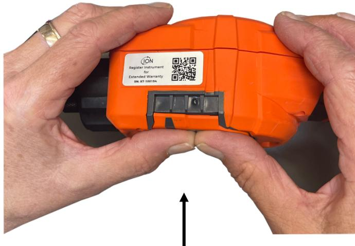
Quando senti che si è agganciato, spingi il resto del coperchio del sensore sul corpo dello strumento e avvita la vite in basso a sinistra in posizione usando la chiave a brugola da 3 mm A/F.
