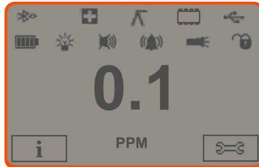
Lo schermo centrale principale visualizzerà le letture solo in numeri grandi, fino a 4 cifre e decimali, da 0,0 ppm a 5.000 ppm. Quando la portata massima viene superata e il sensore si sovraccarica, il display visualizza "9999". Due punti dello schermo sono stati riservati agli indicatori dei tasti funzione. L'area tra gli indicatori dei tasti funzioni mostra le unità di misura.
