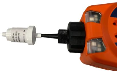
Premere **Invio** per avviare il conto alla rovescia dello "zero". Al termine del conto alla rovescia apparirà un segno di spunta '✓', a indicare che lo Zero è stato accettato. Scollegare il gruppo del filtro a carbone e sostituire le estremità del tappo. La vita utile del gruppo filtro a carbone si riduce se il gruppo filtro a carbone rimane aperto all'atmosfera per periodi prolungati.
