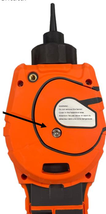
Una volta che la vite è allentata, tirare delicatamente il lato destro del coperchio del sensore dal corpo dello strumento finché non si sente che il coperchio del sensore si è sganciato dalle porte di ingresso/uscita. Una volta sganciato, tirare delicatamente l'intero coperchio del sensore dal corpo dello strumento.
