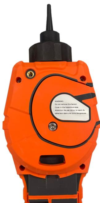
Estrarre delicatamente il lato destro del coperchio del sensore dal corpo dello strumento
