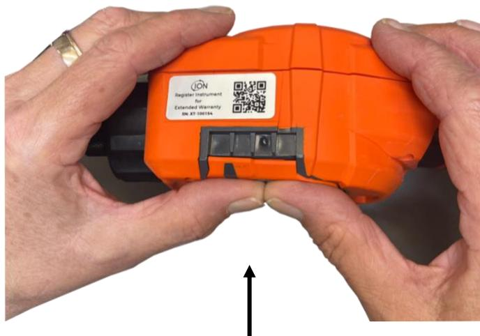
Une fois que vous entendez qu'il est engagé, poussez le reste du couvercle du capteur sur le corps de l'instrument et vissez la vis inférieure gauche en place à l'aide de la clé Allen A/F de 3 mm.
