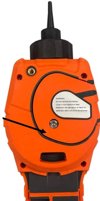
Une fois la vis desserrée, retirez délicatement le côté droit du cache du capteur du corps de l'instrument jusqu'à ce que vous sentiez qu'il est désengagé des ports d'entrée/sortie. Une fois désengagé, retirez délicatement l'ensemble du cache du corps de l'instrument.
