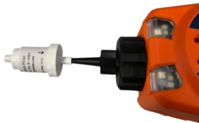
Appuyez sur Entrée pour lancer le compte à rebours. À la fin du compte à rebours, un « coche » s'affiche. ✓' apparaîtra, indiquant que le zéro a été accepté. Débranchez le filtre à charbon et remettez les embouts. La durée de vie du filtre à charbon sera réduite si vous le retirez. est ouvert à l'atmosphère pendant des périodes prolongées.
