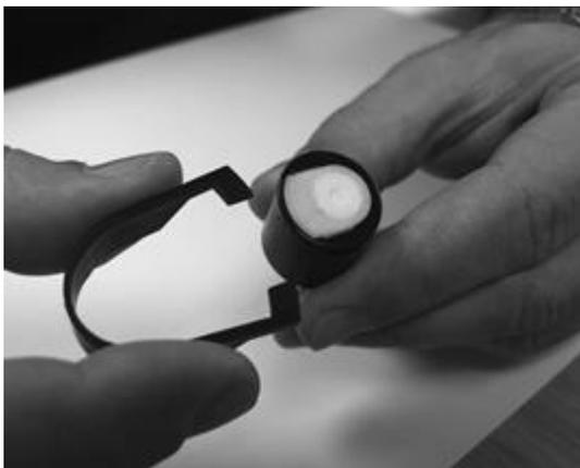
À l'aide de l'outil de retrait de la pile d'électrodes Mini PID fourni, localisez ses « broches » dans les fentes situées sur le côté du corps du capteur Mini PID 2 :
