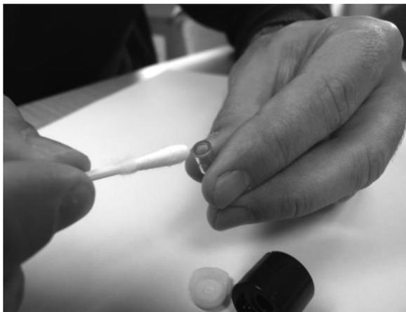
3. Continuez à polir jusqu'à ce qu'un « grincement » audible soit émis par le coton-tige imbibé de composé se déplaçant sur la surface de la fenêtre (généralement dans les quinze secondes).
