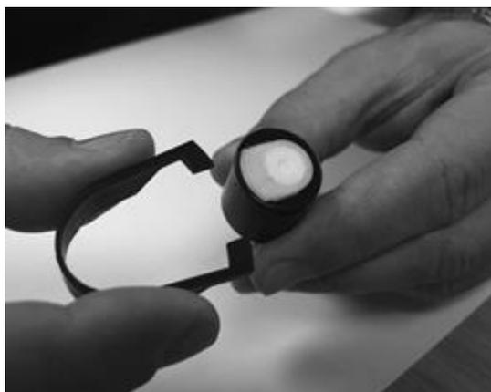
Utilizzando lo strumento di rimozione dell'elettrodo Mini PID fornito, individuare i suoi "rebbi" nelle fessure sul lato del corpo del sensore Mini PID 2:
