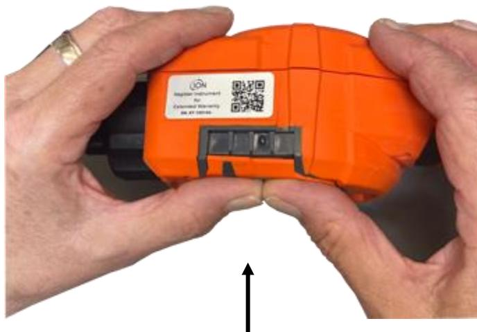
Sobald Sie ein Einrasten hören, drücken Sie den Rest der Sensorabdeckung auf den Gerätekörper und schrauben Sie die untere linke Schraube mit dem 3-mm-A/F-Inbusschlüssel fest.
