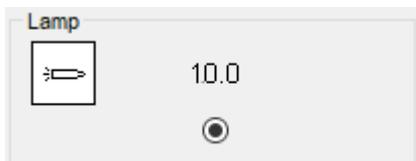
Der TIGER XTS ist nur für die Verwendung mit der 10,0-eV-Lampe konfiguriert.
