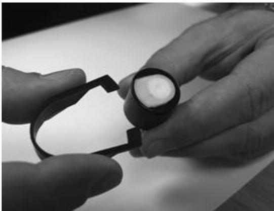
Suchen Sie mit dem mitgelieferten Mini-PID-Elektrodenstapel-Entfernungswerkzeug dessen „Zinken“ in den Schlitzen an der Seite des Mini-PID-2-Sensorgehäuses:
