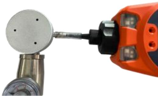
8. Am Ende des Countdowns erscheint ein Häkchen „✓“, das anzeigt, dass SPAN 1 akzeptiert wurde. Drücken Sie die Eingabetaste. Bei einer Zweipunktkalibrierung ist der Kalibriervorgang nun abgeschlossen.
