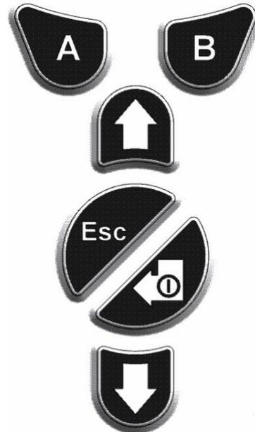
Setup- und Anwendungseinstellungen werden grundsätzlich über die Softkeys ausgewählt und angepasst. Optionen werden mit den Pfeiltasten ausgewählt und mit der Eingabetaste oder einem Softkey bestätigt.
