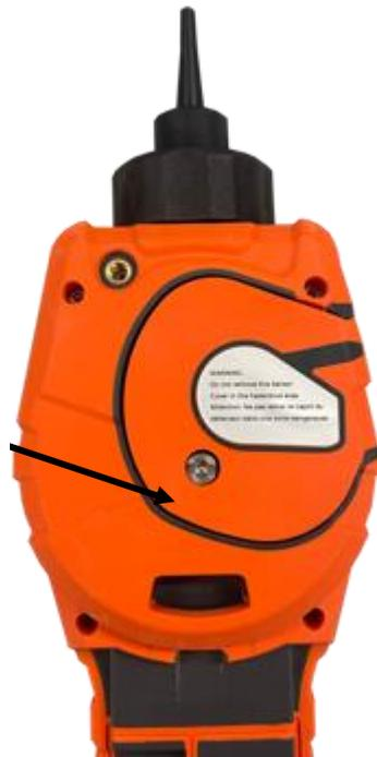
Sobald die Schraube gelöst ist, ziehen Sie die rechte Seite der Sensorabdeckung vorsichtig vom Gerätegehäuse ab, bis Sie spüren, dass sich die Sensorabdeckung von den Einlass-/Auslassöffnungen gelöst hat. Ziehen Sie anschließend die gesamte Sensorabdeckung vorsichtig vom Gerätegehäuse ab.
