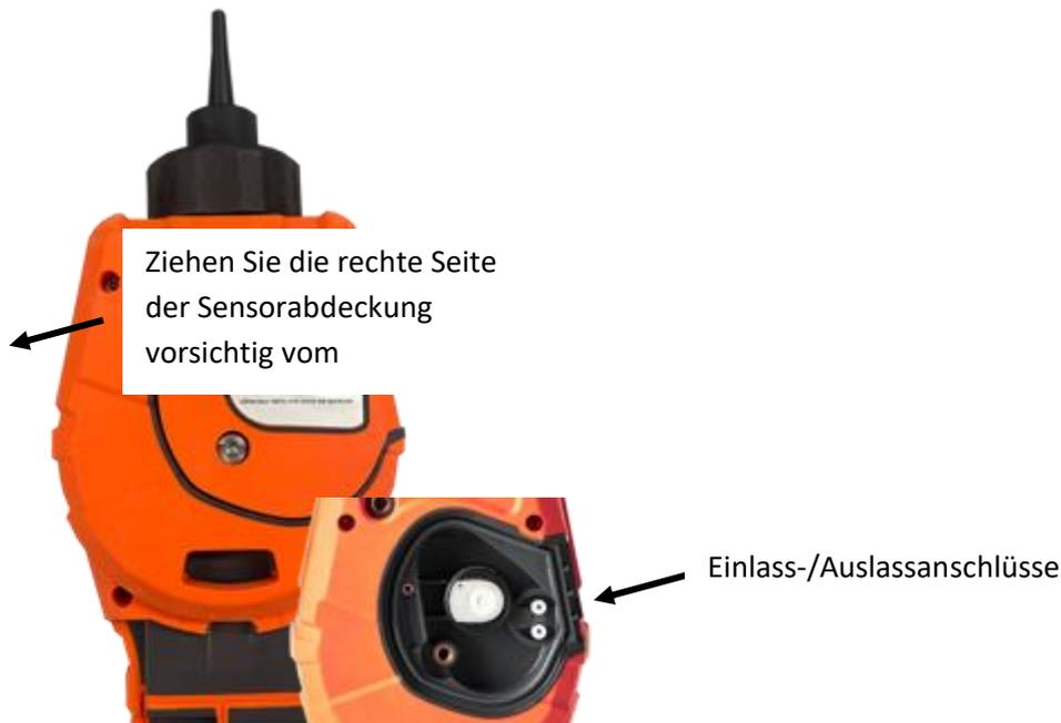
Um die Sensorabdeckung wieder am Gerätekörper anzubringen, richten Sie sie an der Rückseite des Gerätes aus und achten Sie darauf, dass sie mit den Ein-/Auslassöffnungen übereinstimmt. Drücken Sie die rechte Seite der Sensorabdeckung und den Gerätekörper vorsichtig zusammen, bis sie hör- und spürbar einrastet.
