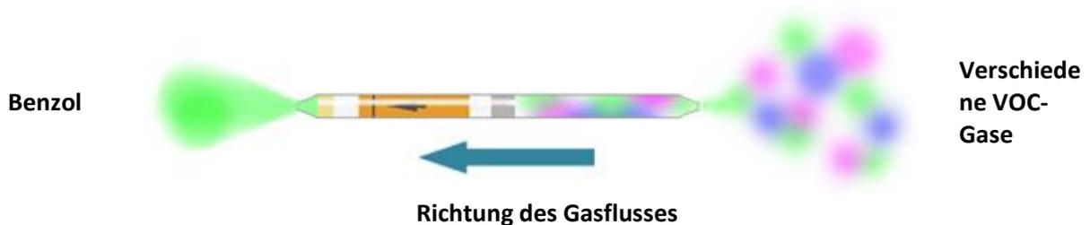
Die Anzahl der von einem PID detektierbaren Gase hängt direkt mit der maximalen Photonenenergie (eV) der verwendeten PID-Lampe zusammen. Da TIGER XTS eine 10,0-eV-Lichtquelle verwendet, werden viele mit Benzol assoziierte Gase aufgrund ihrer höheren eV ignoriert.
