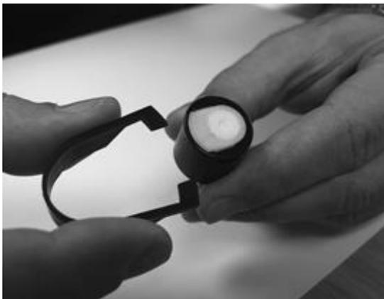
À l'aide de l'outil de retrait de la pile d'électrodes Mini PID fourni, localisez ses « broches » dans les fentes situées sur le côté du corps du capteur Mini PID 2 :
