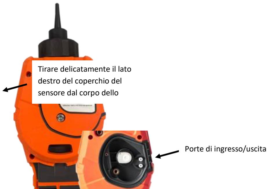
Per rimontare il coperchio del sensore sul corpo dello strumento, allinearli con il retro dello strumento, assicurandosi che sia allineato con le porte di ingresso/uscita. Spingere delicatamente il lato destro del coperchio del sensore e il corpo dello strumento insieme fino a sentire e percepire l'avvenuto aggancio.
