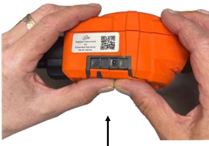
Una volta sentito che è scattato, spingere il resto del coperchio del sensore sul corpo dello strumento e avvitare la vite inferiore sinistra in posizione utilizzando la chiave a brugola da 3 mm A/F.
