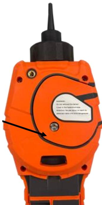
Una volta allentata la vite, tirare delicatamente il lato destro del coperchio del sensore dal corpo dello strumento fino a sentire che il coperchio si è sganciato dalle porte di ingresso/uscita. Una volta sganciato, tirare delicatamente l'intero coperchio del sensore dal corpo dello strumento.
