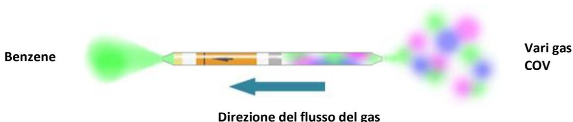
Il numero di gas che un PID può rilevare è direttamente correlato all'energia massima dei fotoni (eV) della lampada PID utilizzata. Poiché TIGER XTS utilizza una sorgente luminosa da 10,0 eV, molti gas associati al benzene vengono ignorati a causa del loro eV più elevato.
