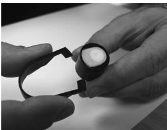
Utilizzando lo strumento di rimozione dell'elettrodo Mini PID fornito, individuare i suoi "rebbi" nelle fessure sul lato del corpo del sensore Mini PID 2:
