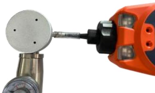
8. Al termine del conto alla rovescia apparirà un segno di spunta "✓", a indicare che lo SPAN 1 è stato accettato. Premere Invio. Per una calibrazione a due punti, la procedura di calibrazione è completa.
