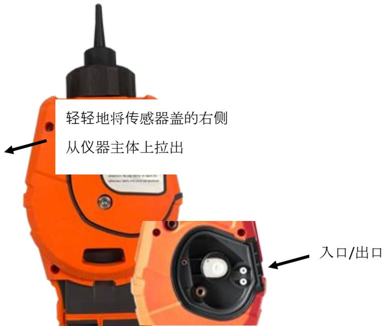
要将传感器盖重新安装到仪器主体上，请将传感器盖与仪器背面对齐，确保其与进/出水口对齐。轻轻将传感器盖的右侧与仪器主体推到一起，直到听到并感觉到其已卡入。
