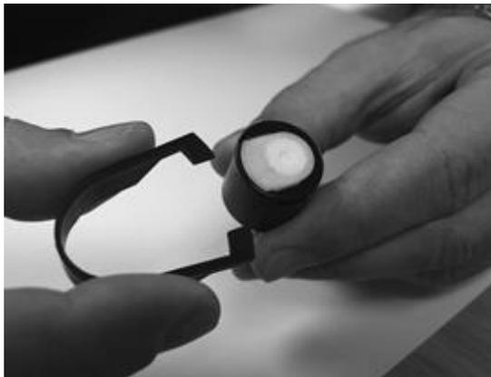
使用提供的 Mini PID 电极堆栈拆卸工具，将其“叉子”放置在 Mini PID 2 传感器主体侧面的插槽中：
