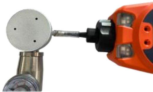
8. 倒计时结束时，将出现一个勾号“√”，表示 SPAN 1 已接受。按 Enter 键。对于两点校准，校准过程已完成。
