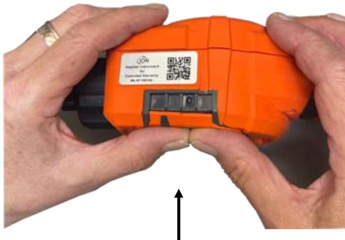
一旦听到它已接合，将传感器盖的其余部分推到仪器主体上，然后使用 3mm A/F 内六角扳手将左下角螺丝拧入到位。
