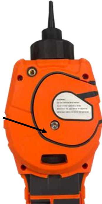
螺丝松开后，轻轻地将传感器盖的右侧从仪器主体上拉出，直到感觉传感器盖已从进/出气口脱离。脱离后，轻轻地将整个传感器盖从仪器主体上拉出。
