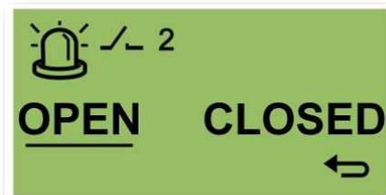
Nella schermata di test del relè, alternare tra APERTO e CHIUSO per azionare manualmente il relè.
