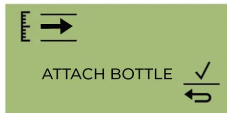
Collegare la bottiglia prima di iniziare la calibrazione. Ciò garantisce che il benzene fluisca attraverso il sistema Titan 2 prima dell'inizio della calibrazione.
